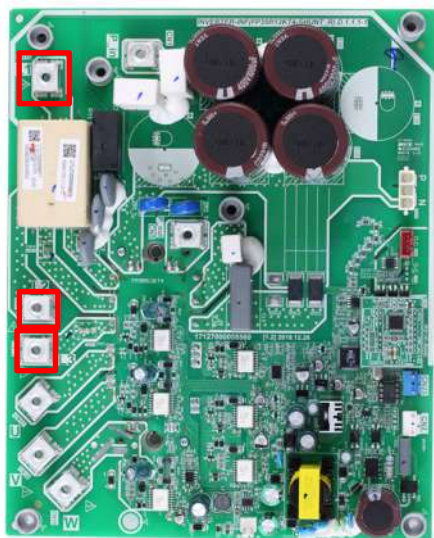
Obrázok 4-5.7: Zapojenie kábla DC zbernice (L1L2L3, PIN- POUT)
