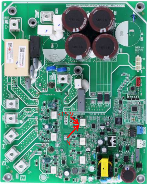
Obrázok 4-5.10: Svorka P N +15 V – +15 V (IC4/5/6PIN12); N – (IC/4/5, 6) PIN13
